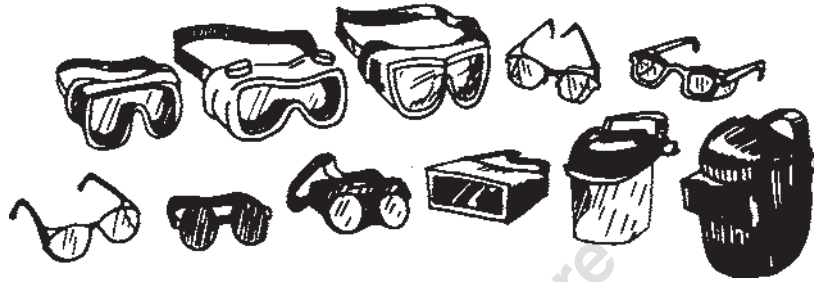
شکل ۳۵-۳. انواع فیلترهای چشمی برای محافظت در برابر پرتوهای فرابنفش یا مادون قرمز
