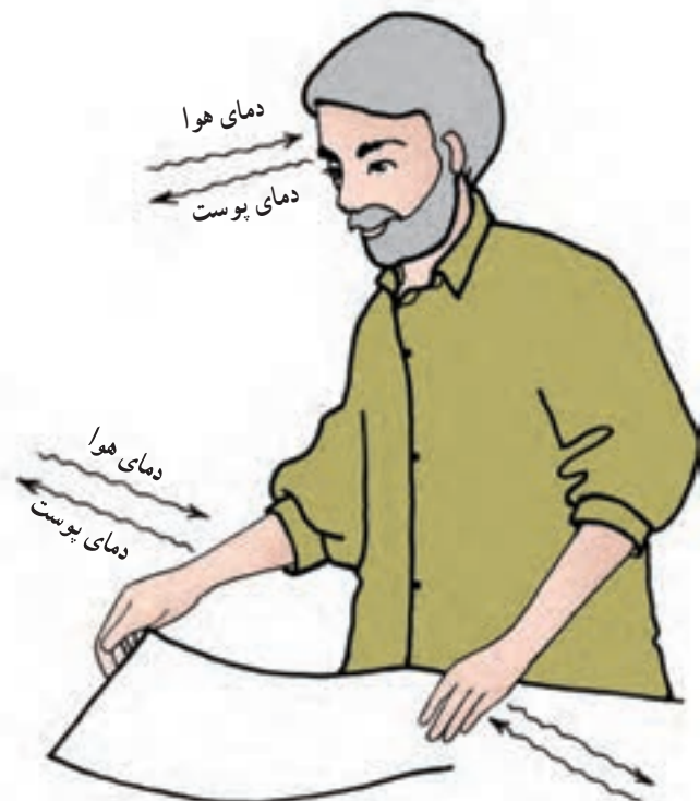
شکل ۱۳-۳- انتقال گرما از راه جابجایی
