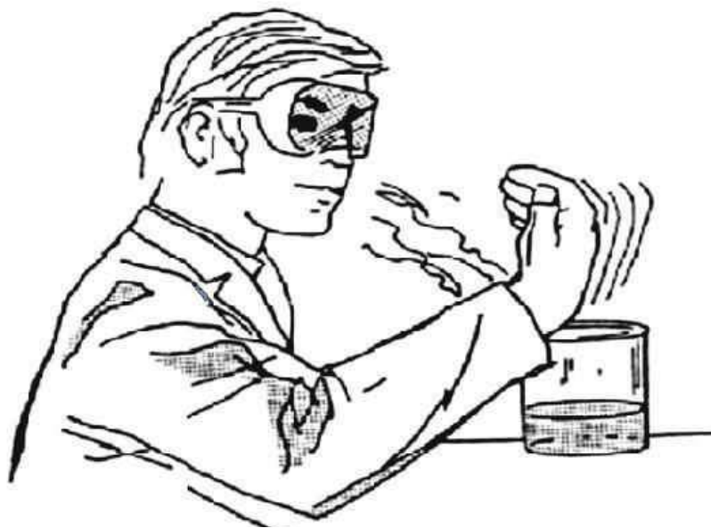
شکل ۵-۲: روش صحیح بو کردن مواد
