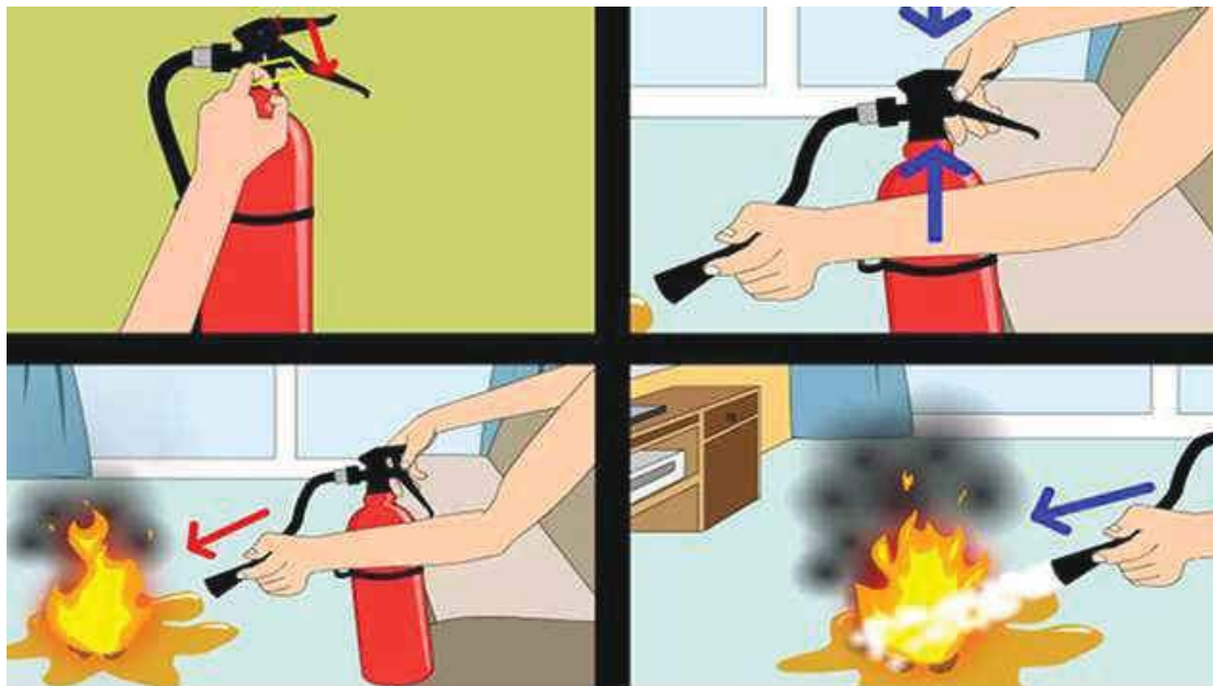
استفاده صحیح از کپسول آتش نشانی
