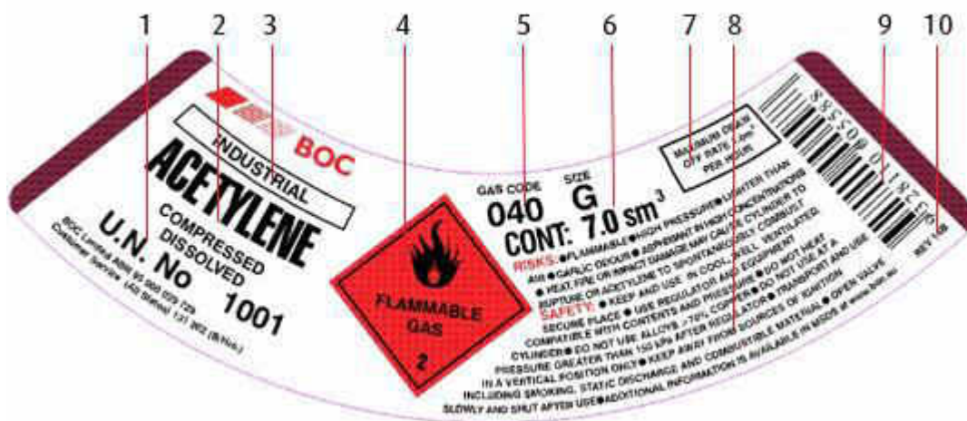
شکل ۴- ۲۳: برچسب شناسایی سیلندر
