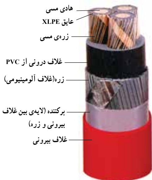
شکل ۳۹-۴ کابل با غلاف آلومینیومی
