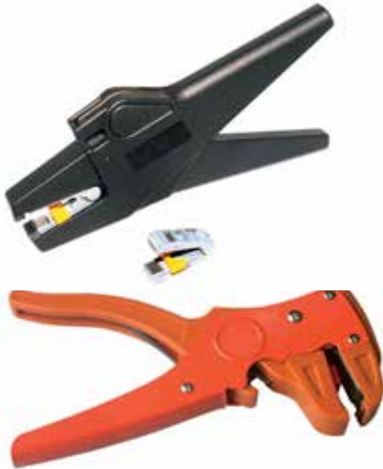
شکل ۳-۱۴ دو نمونه ی دیگر از سیم لخت کن های خودکار
